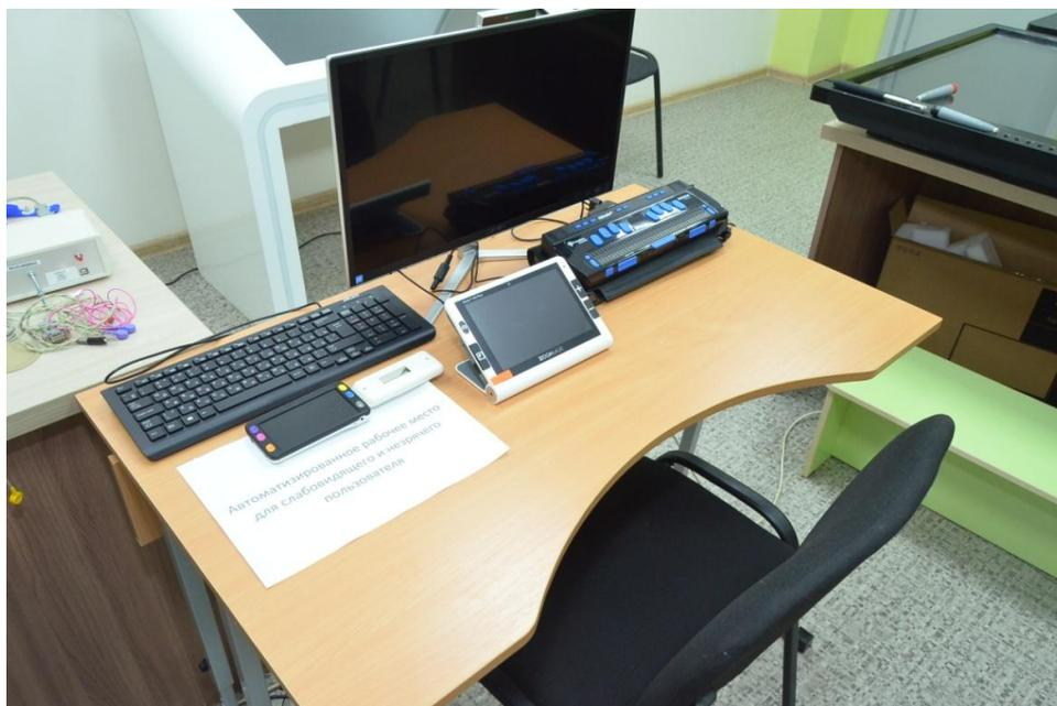
Портативный компьютер с вводом/выводом шрифтом Брайля и синтезатором речи предназначен для слабовидящих, незрячих пользователей, а также пользователей с одновременной потерей зрения и слуха.
