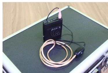
Передатчик оснащается микрофоном. Полученный сигнал приемник может вывести как на наушники, так и на заушный индуктор или индукционную петлю для слабослышащего пользователя.
