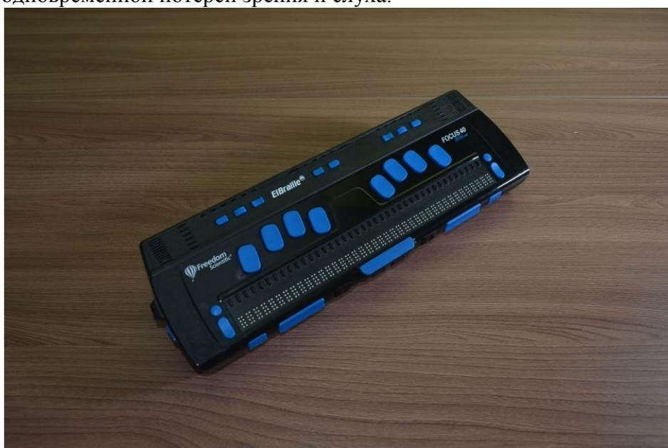
Пользователь может использовать Брайль для ввода и Брайль и/или речь для вывода информации. Возможность подключения к ПК через USB-порт. Устройство работает в автономном режиме и в режиме дисплея Брайля, а также имеет возможность автоматического и принудительного переключения режимов.
