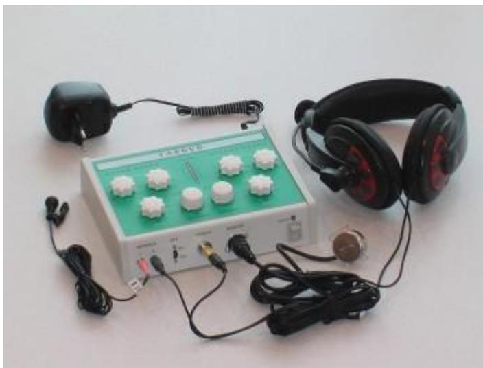
В зависимости от степени снижения слуха, устройство обеспечивает на каждое ухо отдельно индивидуальный выбор усиления и выбор частотного диапазона. В аппарате используется компрессия звукового сигнала с амплитудой, которая особенно подойдет для людей с синдромом ускоренного нарастания громкости. Аппарат оснащен тактильно-вибрационным рисунком и подойдет для использования обучающихся с проблемами органа зрения.
