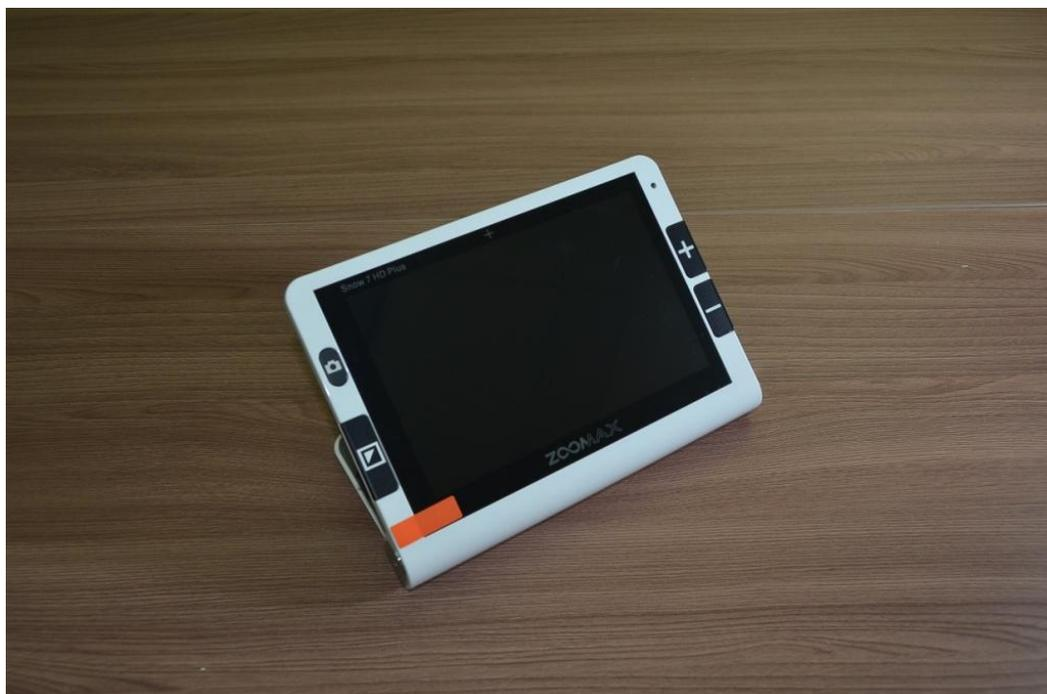
Возможность преобразования текста в речь помогает слушать и следить за текстом одновременно. Устройство позволяет плавно увеличивать изображения и текст от 2,5 до 19 крат, а также просматривать дальние объекты (до 5 м), это обеспечивает наличие 13-мегапиксельной камеры с ближним и дальним режимами просмотра. Обладает функциями: стоп-кадр, чтение полной страницы, линии чтения и хранение до 1000 изображений. Позволяет использовать увеличитель в качестве читающей машины.
