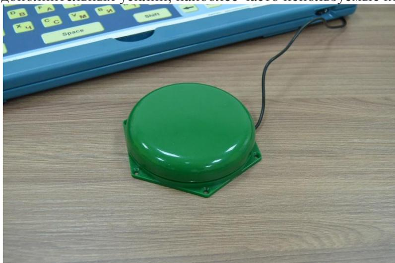
Кнопка работает на всей площади поверхности с использованием минимального усилия. Заменяет по функциональности компьютерную мышь. От 4 до 8 выбираемых направления движения, каждое направление с светодиодной подсветкой 8 выбираемых режимов скорости сканирования.
