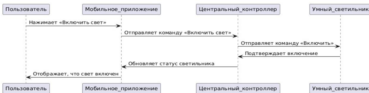
Рисунок 1 - Диаграмма последовательности процесса управление освещением
