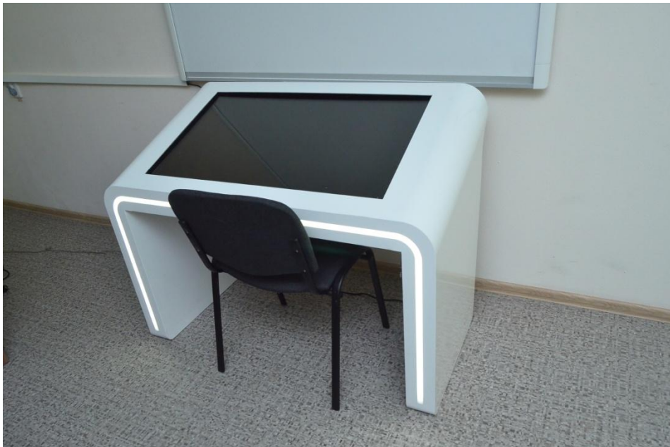
Сенсорный интерактивный стол с инфракрасным экраном с мультитач-системой в 10 касаний и встроенным компьютером
